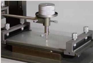
各種素材の引掻強度及び各種膜、塗料膜などの付着性を評価します。
