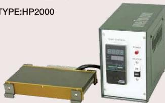
室温+10℃から200℃の範囲で試験片を加熱させることが出来ます。トライボギアの摺動テーブルに取り付けて使用する事が出来ます。
