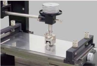
円筒状のローラーを固定し線圧を加えて滑らせます。SUS製のローラーが付属。
