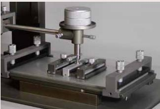
シート形状試験片を巻き付けて固定、平板形状試験片は、接着により対試験片に面圧をかける事が出来ます。
