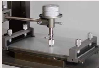
平板及びシート状試験片に、固定されたボールで点圧を加え、滑らせます。ボールを基準として、試験片間の差を求めめるのに適します。
