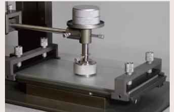
スチールウール、ガーゼ、ゴムなどを固定して、試験片面の変化を測定します。
